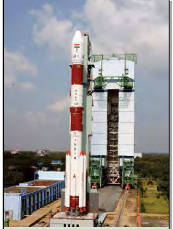
ಮಂಗಳ ಕಕ್ಷೆಗಾಮಿ ಅಭಿಯಾನವನ್ನು ಹೊತ್ತೊಯ್ಯುವ ಪಿ ಎಸ್ ಎಲ್ ವಿ ಸಿ-25 ರಾಕೆಟ್‌ನ ಭಾಯಾಚಿತ್ರ. ರಾಕೆಟ್ 45 ಮೀ ಎತ್ತರ, 3 ಮೀಟರ್ ವ್ಯಾಸವನ್ನು ಹೊಂದಿದ್ದು ಸುಮಾರು 300 ಟನ್ ತೂಗುತ್ತದೆ. ಈ ರಾಕೆಟ್ ಭೂಸ್ಥಾಯೀ ಕಕ್ಷೆಗೆ 1500 ಕೆಜಿ ವರೆಗಿನ ತೂಕದ ಪೇಲೋಡ್ ಅನ್ನು ತಲುಪಿಸಬಲ್ಲದು. © ಇಸ್ರೋ
