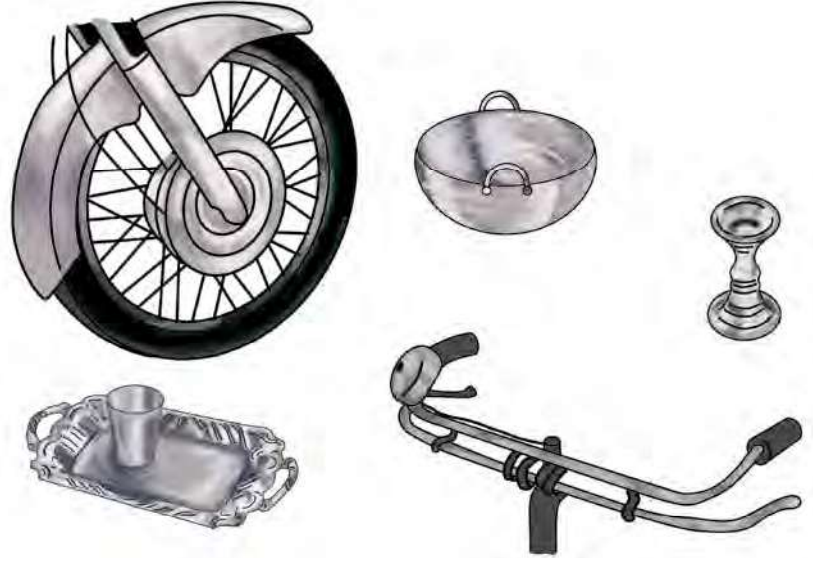
ಚಿತ್ರ 4. 8ನೇ ತರಗತಿಯ ವಿಜ್ಞಾನ ಪಠ್ಯಪುಸ್ತಕದ (ಎನ್.ಸಿ.ಇ.ಆರ್.ಟಿ., 2024-2025) ಅಧ್ಯಾಯ 11 ('ವಿದ್ಯುತ್ ಪ್ರವಾಹದ ರಾಸಾಯನಿಕ ಪರಿಣಾಮಗಳು') ರಲ್ಲಿರುವ ಚಿತ್ರಣದಿಂದ ಅಳವಡಿಸಿಕೊಳ್ಳಲಾಗಿದೆ. ಈ ಚಿತ್ರವು ವಿದ್ಯುಲ್ಲೇಪನದ ಕೆಲವು ಸಾಮಾನ್ಯ ಉಪಯೋಗಗಳನ್ನು ತೋರಿಸುತ್ತದೆ.
