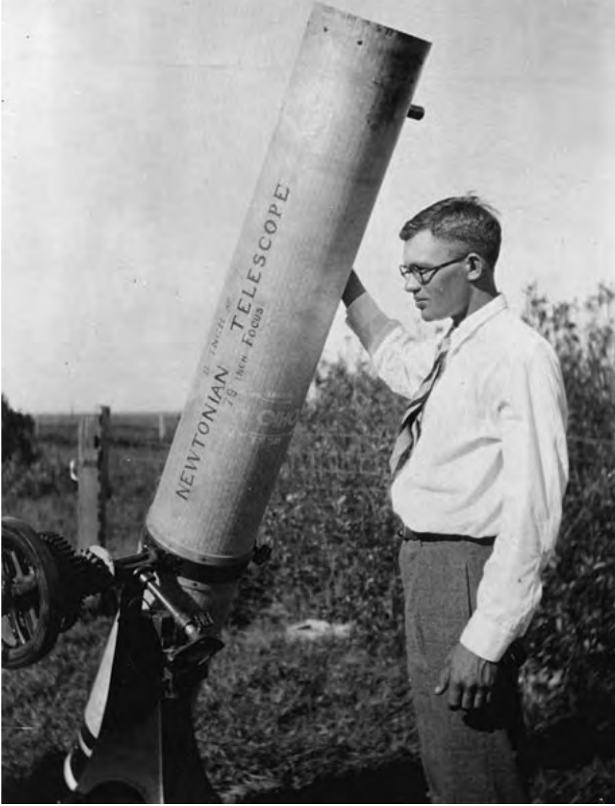
ಚಿತ್ರ 2. ಮನೆಯಲ್ಲೇ ನಿರ್ಮಿಸಿದ ತಮ್ಮ 9 ಇಂಚಿನ ದೂರದರ್ಶಕದೊಂದಿಗೆ ಕ್ಲೈಡ್ ಟೋಂಬಾ. ಅದರಲ್ಲಿ ಬಳಸಿದ ಕನ್ನಡಿಗಳನ್ನು ಟೋಂಬಾ ತಾವೇ ಸ್ವತಃ ಉಜ್ಜಿ ತಯಾರಿಸಿದ್ದರು. ತಮ್ಮ ತಂದೆಯ 1910ರ ಬ್ಯೂಯಿಕ್ ಕಾರಿನ ವಂಕದಂಡದ ಭಾಗವನ್ನು ಮತ್ತು ತಮ್ಮ ಜಮೀನಿನಲ್ಲಿ ಬಳಸಲಾಗುತ್ತಿದ್ದ ಒಂದು ಕ್ರೀಮು ಬೇರ್ಪಡಿಸುವ ಯಂತ್ರದ ತ್ಯಾಜ್ಯ ಭಾಗಗಳನ್ನು ಬಳಸಿಕೊಂಡು ದೂರದರ್ಶಕಕ್ಕಾಗಿ ತಮ್ಮದೇ ಸ್ವಂತ ಆಧಾರ ಪೀಠವನ್ನೂ ನಿರ್ಮಿಸಿದ್ದರು. ಗುರು ಮತ್ತು ಮಂಗಳ ಗ್ರಹಗಳ ಮೇಲ್ಮೈಗಳ ಮೇಲಿನ ಗುರುತುಗಳನ್ನು ಅವರು ವೀಕ್ಷಿಸಲು ಸಾಧ್ಯವಾಗುವಂತೆ ಮಾಡಿದ್ದು ಇದೇ ದೂರದರ್ಶಕ.
